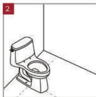
Ubique el sanitario sobre la boca del desagüe, verificando que coincidan a la perfección. Marque con lápiz los puntos destinados a los tornillos de sujeción. Realice un orificio en cada uno de ellos con el taladro e inserte el chazo correspondiente.
