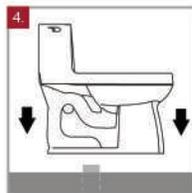
4. Levante la taza y lleve el sanitario hasta el sitio de instalación y asíéntelo con suavidad, sobre la salida del tubo de desagüe. Verifique que los orificios de sujeción coincidan con los chazos del piso.
